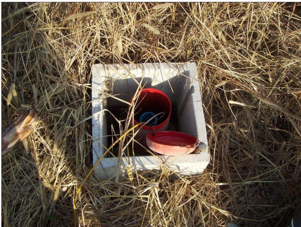
Sondaggio meccanico S1 strumentato con piezometro a tubo aperto e sua ubicazione (aerofoto tratta da GoogleMaps)
